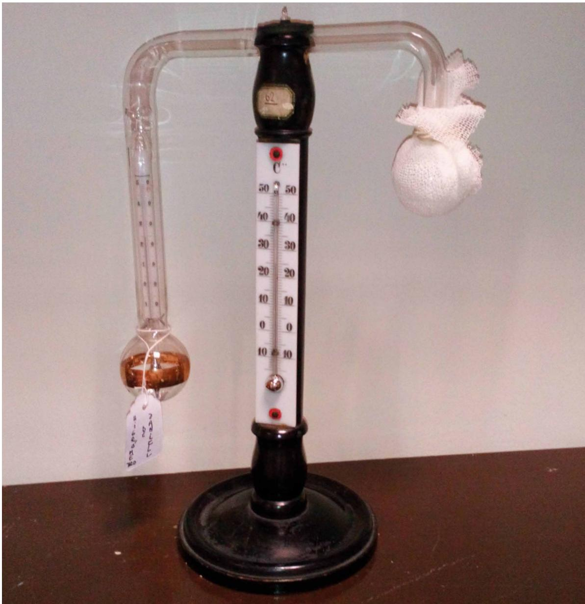
Higrómetro de Daniell perteneciente al Museo Escolar de la Escuela N° 1 D.E. 6 “Esteban De Luca”. Este instrumento de laboratorio permite medir el grado de humedad del aire, era utilizado para la enseñanza de la física. Consta de dos bolas de vidrio con cobalto unidas por un tubo dos veces encorvado y un termómetro fijado sobre el soporte. Pertenece a la familia de los higrómetros de condensación.
