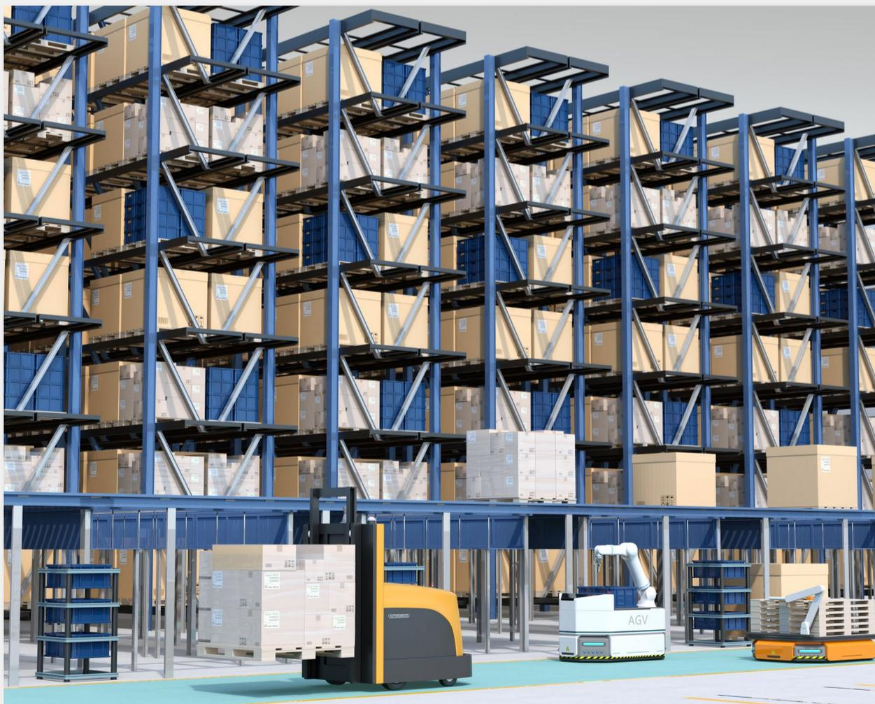
Depósito automatizado con robots móviles.
