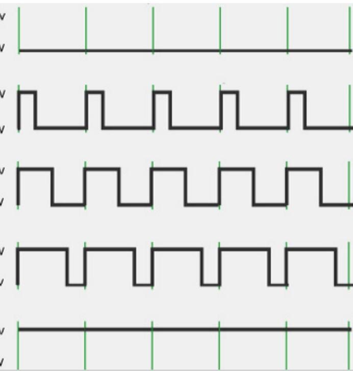
Estos motores funcionan con una señal PWM (modulación por ancho de pulso), con un pulso de trabajo entre 1 ms y 2 ms y con un período de 20 ms (50 Hz). Es decir, puede moverse con una resolución de más de 1 grado, que es el máximo, y esto dependerá del tipo y marca de nuestro servo.
