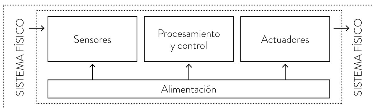
Los sensores obtienen información del mundo físico externo y la transforman en una señal eléctrica, que puede ser manipulada por la circuitería interna de control. Existen sensores de todo tipo: de temperatura, de humedad, de movimiento, de sonido (micrófonos), etcétera.
