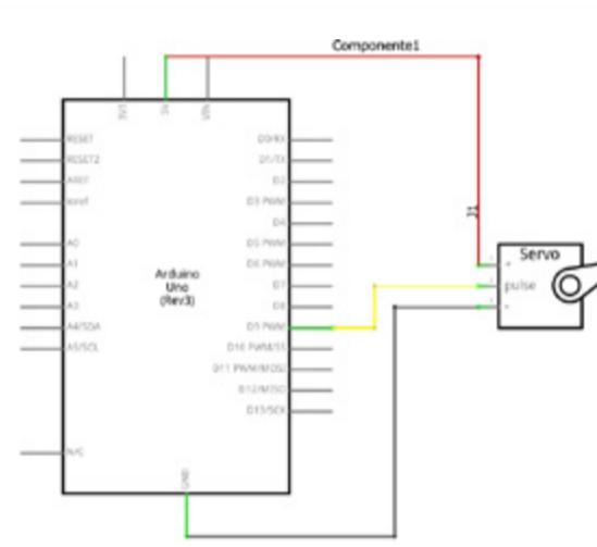
El Arduino marca los pines de PWM con el símbolo ~ junto al pin digital.
