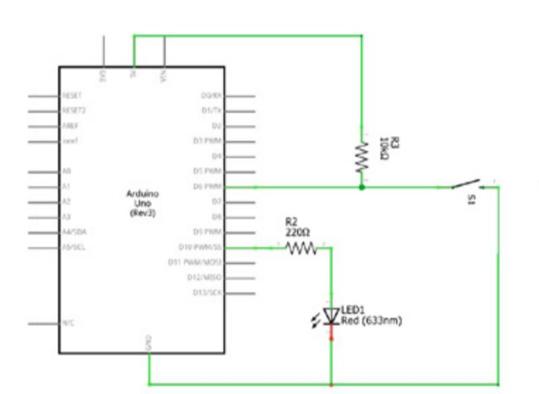
Obsérvese que, mientras no pulsemos S1, el pin 6 de Arduino está conectado a 5V a través de la resistencia R3, forzando una lectura de tensión alta (HIGH). En cambio, cuando pulsamos S1, cerraremos el circuito del pin 6 a Ground, con lo que leerá tensión baja, LOW. En ambos casos, tenemos un valor de tensión definido.
