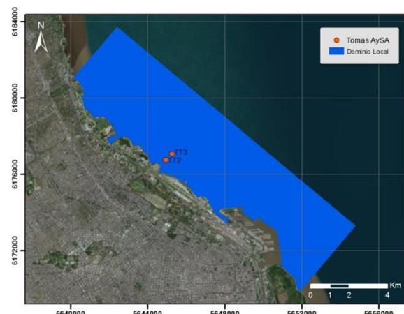
Estos modelos se configuraron sobre la base de un Modelo Digital de Elevación (MDE) del fondo del Río de la Plata elaborado en base a cartas del Servicio de Hidrografía Naval (SHN), complementadas con relevamientos batimétricos de detalle de AySA, ORSNA y EIH.
