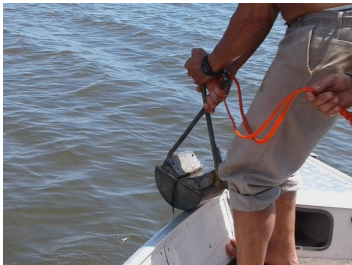
Figura 47. Toma de muestra de sedimentos del lecho
