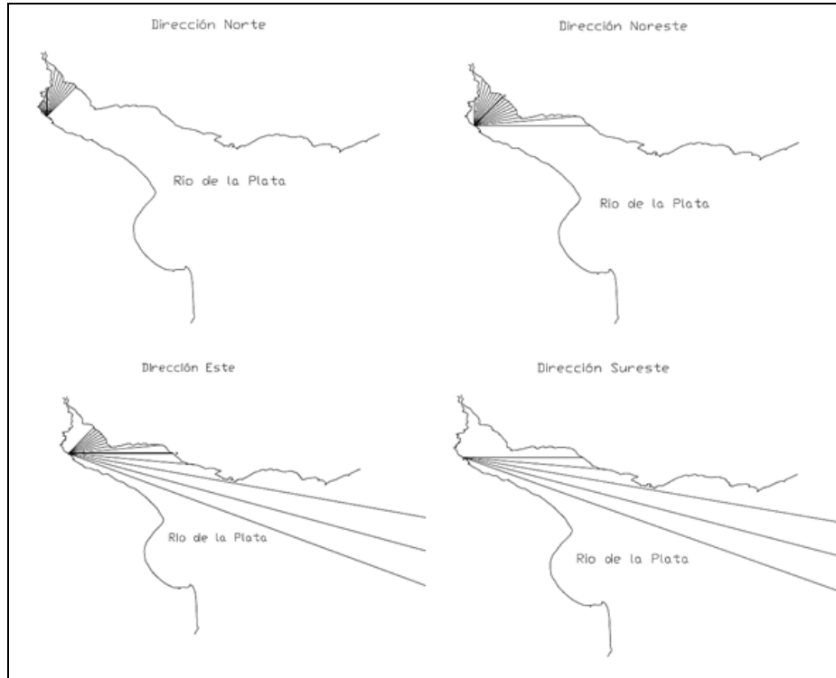
Figura 46. Fetch efectivo direcciones N, NE, E, S
