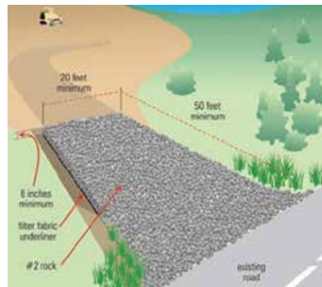
Fig. 20: Estabilización de salida de vehículos
