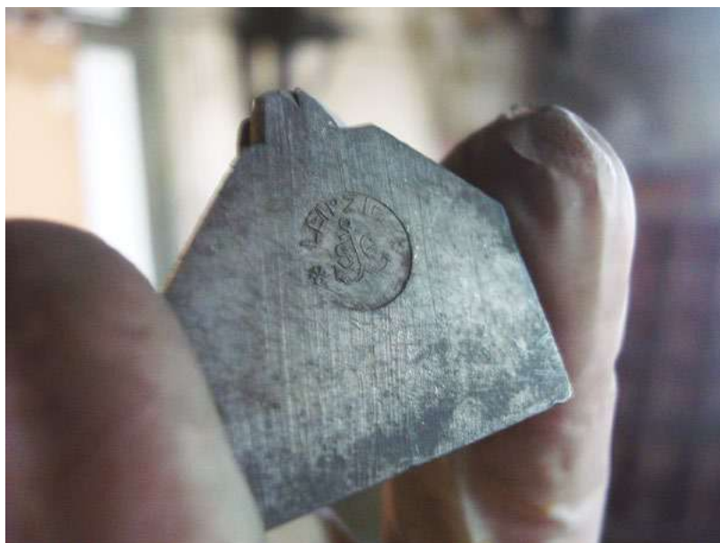
Tipo móvil con el sello de Schelter & Giesecke, de Leipzig, una letra cursiva ofrecida especialmente por Curt Berger & Cía.
