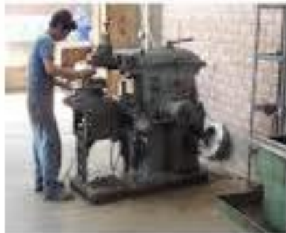
Operario trabajando sin EPP en el sector de Fresado
