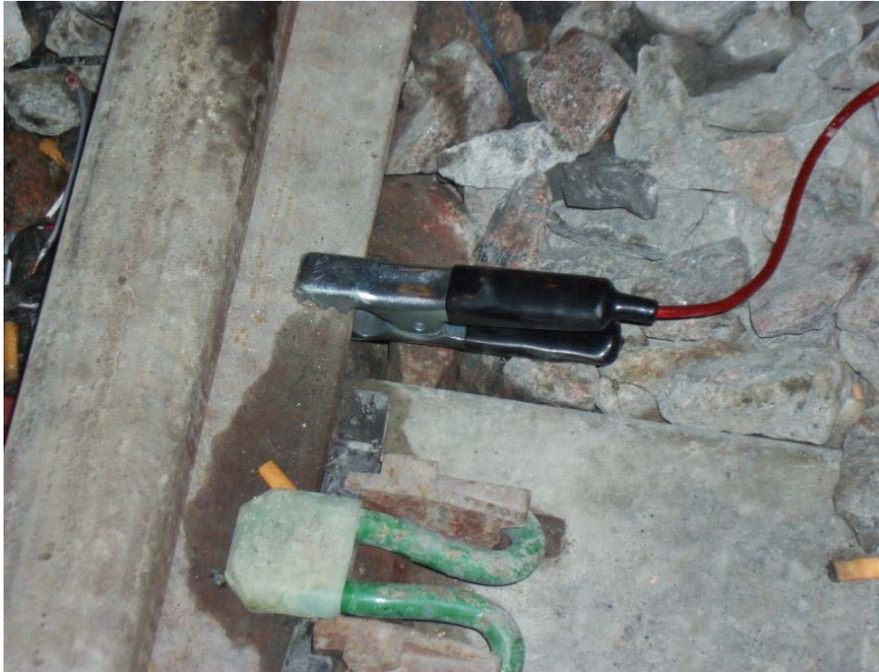
Fig. 3: colocación de mordaza (cocodrilo) al riel
