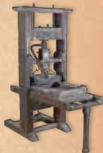
Prensa común ( common press ) del siglo XVIII, con estructura de madera y partes mecánicas de hierro.
