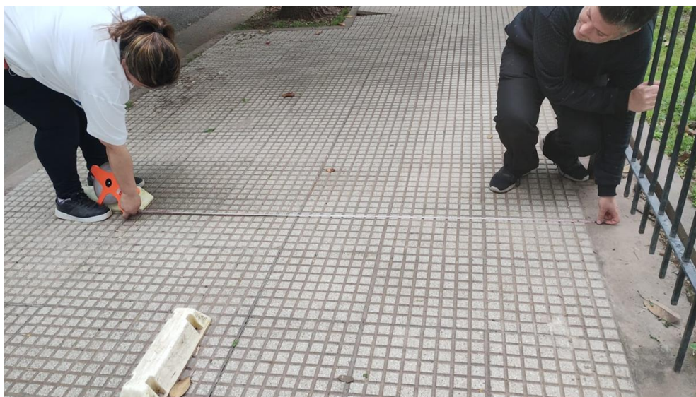
Imagen 2. Balizado de un punto muestra mediante la utilización de cinta métrica, tomando como referencia un objeto estático.
