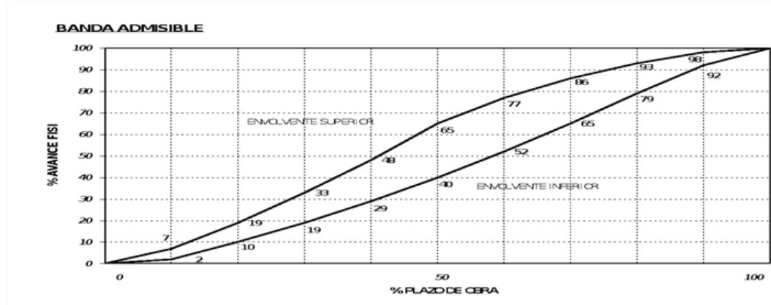
BANDA ADMISIBLE PARA CURVAS DE AVANCE FÍSICO NORMAL PARA CONSTRUCCIÓN TRADICIONAL
