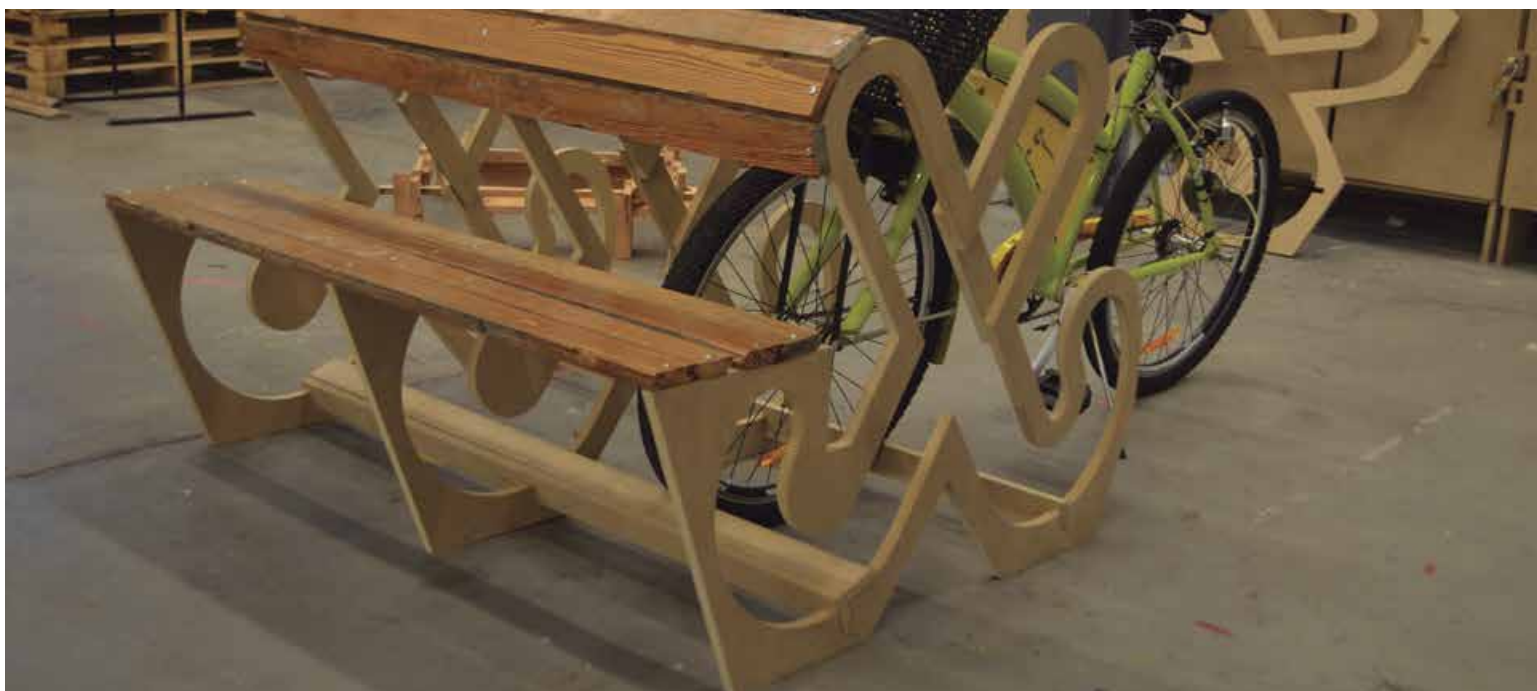
María Luisa Martín Asiento y estacionamiento para bicicleta con maderas recuperadas y pieza en MDF realizada en corte láser.
