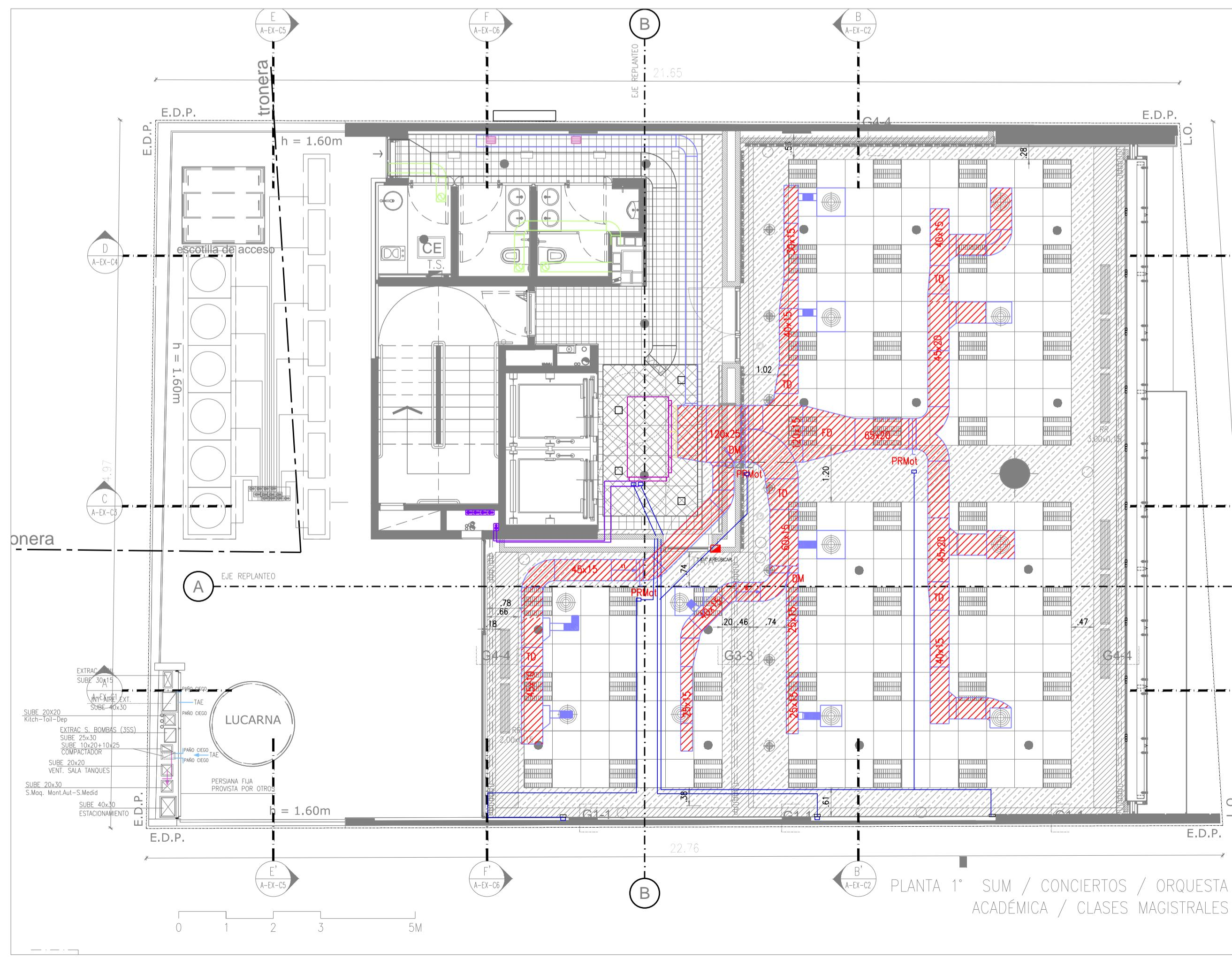
**CONDUCTOS NUEVOS CLIMAVER NETO + Doble placa de Alta densidad 12.5mm (Diamant) en caras laterales en inferiores**
