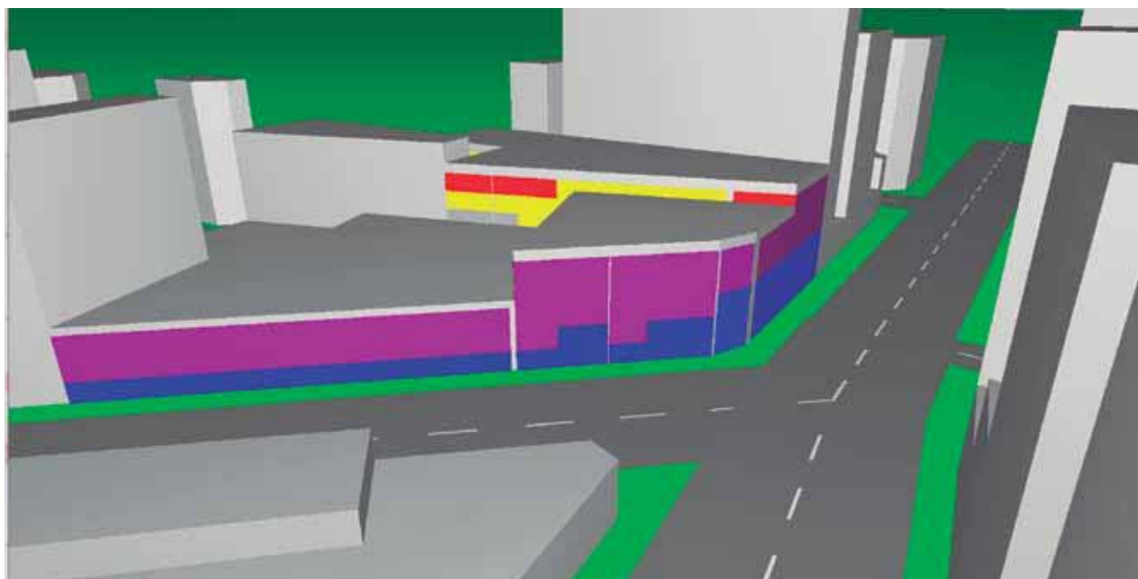
Figura 1: Proyección de valores de ruido sobre la fachada en una esquina
