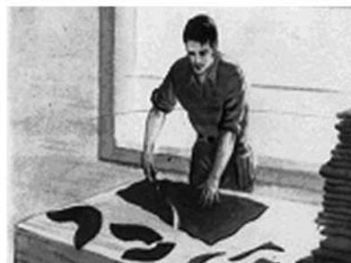
Con una cuchilla se cortan las partes del calzado.
