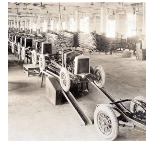
Vista de la fábrica de automóviles de Henry Ford. La "cadena de montaje" en pleno funcionamiento.
