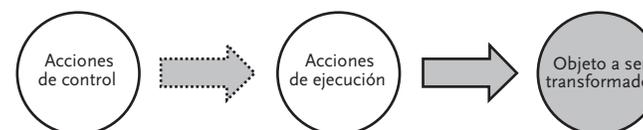
Trasladando este esquema al de una mano robótica que opera en alguna industria o laboratorio, el “agarre” final de los dedos (acción de ejecución) es producto de todo un proceso de posicionamiento, generalmente bajo control de una computadora preprogramada (acciones de control).
